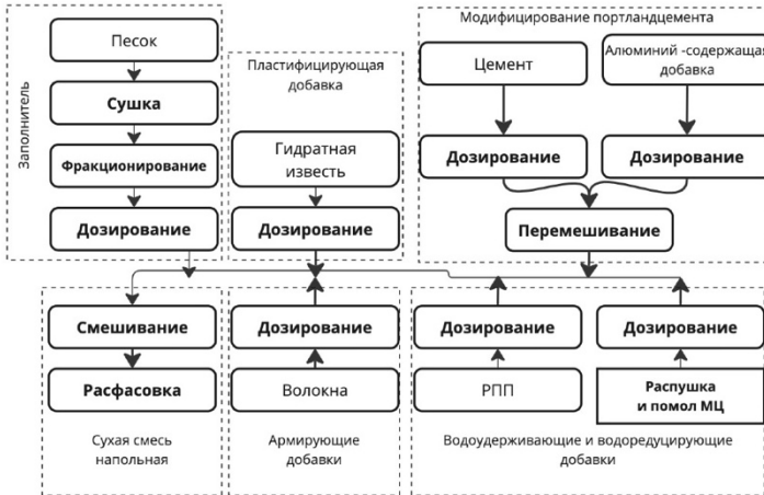
Рисунок 8 – Технологическая схема производства сухой напольной смеси
